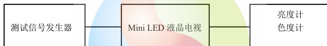
图 1 平板 Mini LED 背光液晶电视测量设备方框图
